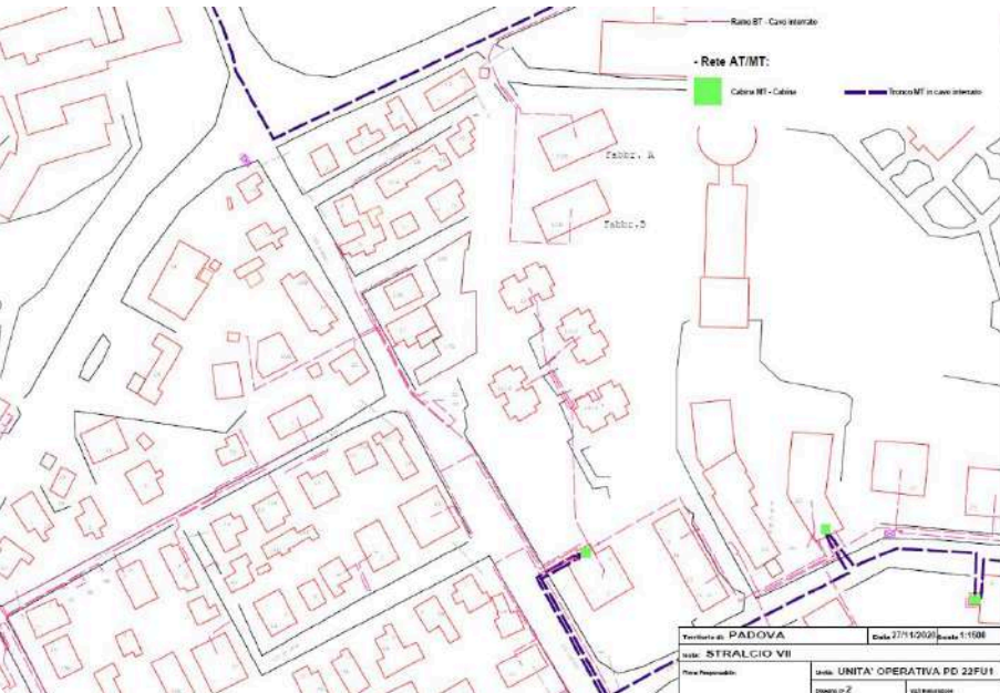
Rete elettrica BT/MT in cavo interrato in via Antonio Sografi (E-Distribuzione S.p.A.)
